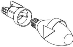
*Fig. 19: Remplacement de la lampe halogène*
