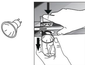
Pour remplacer les lampes halogènes, poussez le support de la lampe vers le bas en le tenant par l'arrière, tournez-le un peu dans le sens antihoraire, et sortez-le par le bas. Fig. 18
