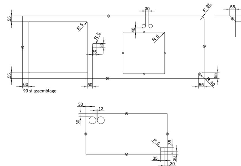
**Afin d'éviter un cintrage les plans doivent être supportés tous les 600 mm**, dans le cas d'une installation **sur un caisson de largeur supérieur (ex 800 mm)** celui-ci **doit être renforcé avec une traverse afin de limiter la distance entre les supports**.
